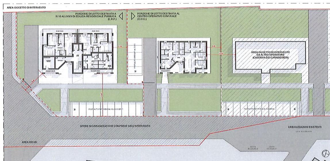
In definitiva l'intervento consta nella realizzazione di due palazzine, una per 10 alloggi ERP, ed una a servizi. Si riporta di seguito un'immagine 3D del complesso dei due fabbricati:
