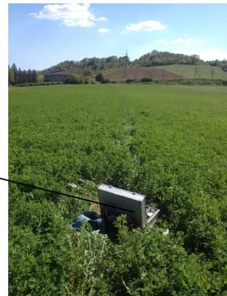
Dato che il caso di un sottosuolo omogeneo può ritenersi solo teorico, i valori di resistività rilevati sono valori di resistività “apparente” ( $\rho_a$ ), influenzati e mediati sull’intero spessore indagato. La resistività apparente si misura in  $\Omega \cdot m$  (Ohm per metro lineare) ed esprime il valore della resistività calcolato con una certa configurazione geometrica ed è dipendente dai valori di resistività dei singoli strati interessati dalla corrente immessa.
