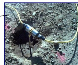
Tramite gli elettrodi **A - B** si immette nel terreno una corrente continua  $I_c$ , mentre tramite gli elettrodi **M-N** viene rilevata la differenza di potenziale  $V$  che si instaura. Conoscendo  $I_c$  e misurando  $V$  si calcola la resistività elettrica relativa alla configurazione elettrodica utilizzata, usando la formula:
