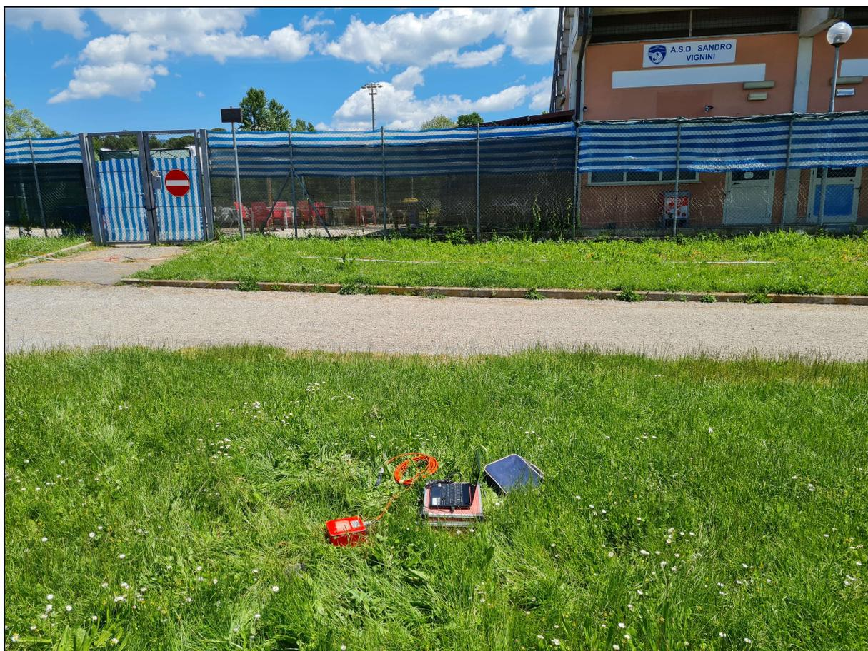
Fase di acquisizione misura di rumore sismico HVSR.
