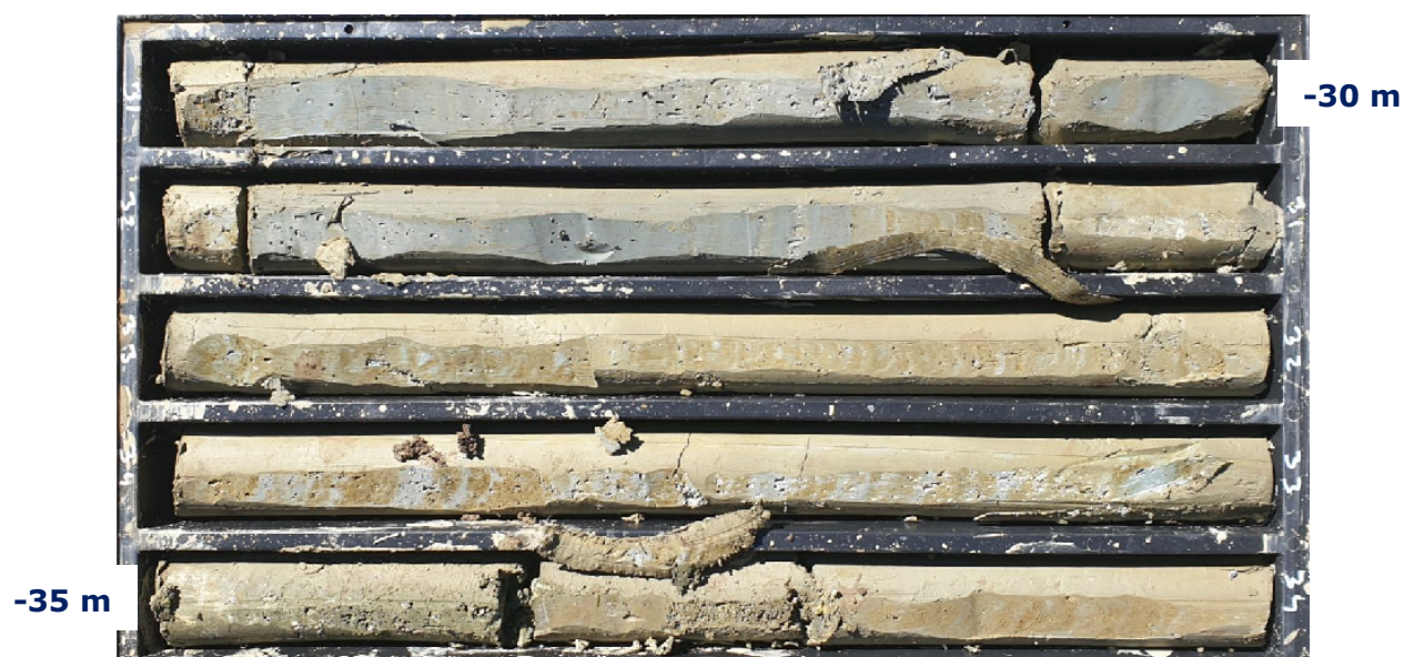
CAROTAGGI 30÷35 m DAL SONDAGGIO GEOGNOSTICO S1
