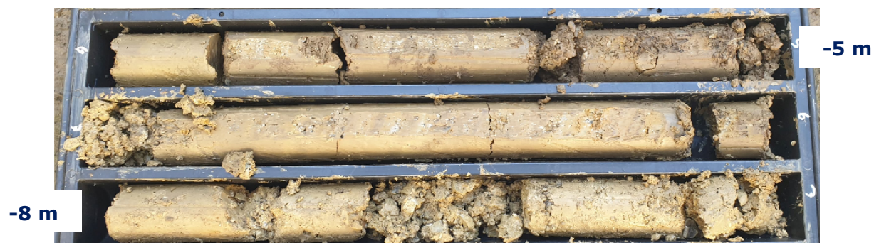
CAROTAGGI 0÷8 m DAL SONDAGGIO GEOGNOSTICO S2
